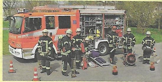
**HLF 10/6 Florian Stuttgart 32/43-01** • 4 Atemschutzgeräte, 3 Watthosen, Wassersauger • Belüftungsgerät, Säbelsäge, Trennschleifer • Hydraulisches Kombi-rettungsgerät • vierteilige Steckleiter, dreiteilige Schiebleiter • Stromerzeuger 5 kVA • Schnellangriffseinrichtung, S25-50m Löschmittelbehälter
